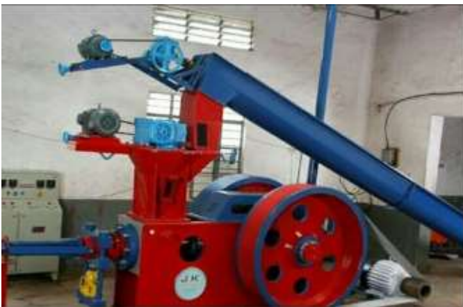
Fig-9: Briquetting press machine.
